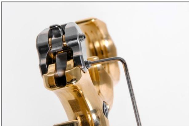
Démontez les axes au moyen de la clé Halen de 1,5 fournie. Prenez garde à toujours utiliser une clé en bon état pour ne pas arrondir l'empreinte de vis. Dévissez et serrez avec délicatesse, comme pour toutes les pièces de votre arc.
